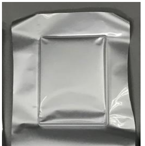
外装材の絞り加工
