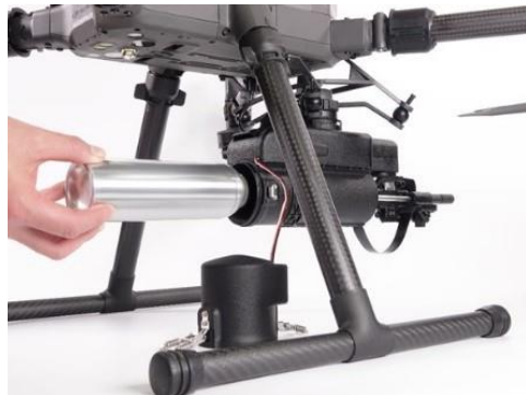
産業ドローン用 遠隔型スプレー缶噴射装置
